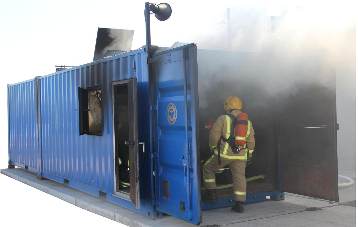
Огневой тренажерный комплекс ПТС «УГОЛЕК» предназначен для проведения практических занятий и тренировок по отработке навыков действия в условиях опасных факторов пожара, таких как задымление, высокая температура, открытое пламя, тепловое излучение, возникающих при сгорании в топке твердого топлива.
