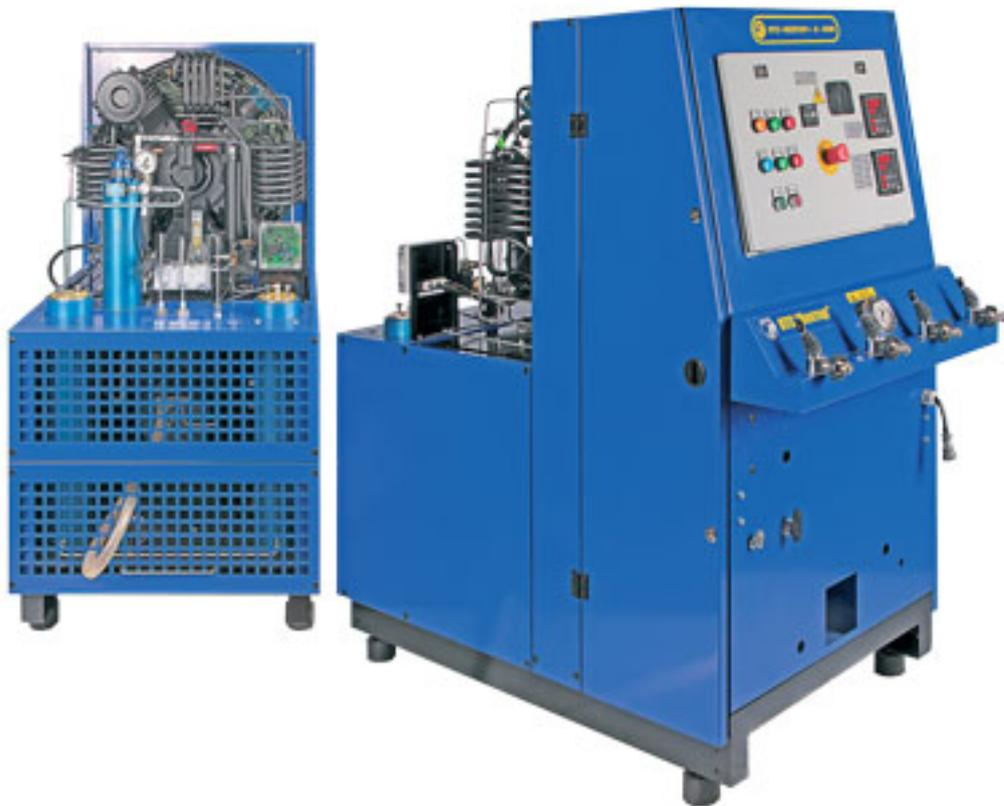
Серия S стационарных профессиональных компрессорных установок производительностью 500 дм<sup>3</sup>/мин, на рабочее давление 45 МПа. Компрессор воздушный высокого давления предназначен для заправки сжатым воздухом баллонов дыхательных аппаратов до давления 45 МПа или 29,4 МПа перепуском из ресивера через понижающий редуктор (ресивер заказывается отдельно и может быть объемом до 200 л).
