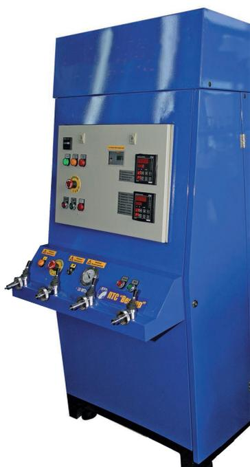
Выполнен в шумопоглощающем корпусе и обладает повышенной производительностью 600 и 700 л/мин, рабочим давлением 29,4 МПа. Тип привода: трехфазный асинхронный с короткозамкнутым ротором мощностью 15 и 18,5 кВт. соответственно. Компрессор воздушный высокого давления предназначен для заправки сжатым воздухом баллонов дыхательных аппаратов.
