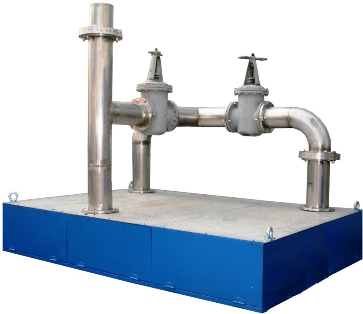
Тренажер представляет собой макет участка газопровода с двумя вентилями и двумя источниками пожара. Каждый из вентилях имитирует перекрытие подачи газа к соответствующему источнику пожара. Диаметр трубопровода 200мм. Материал – нержавеющая сталь. Макет расположен на постаменте высотой 0,5 м.
