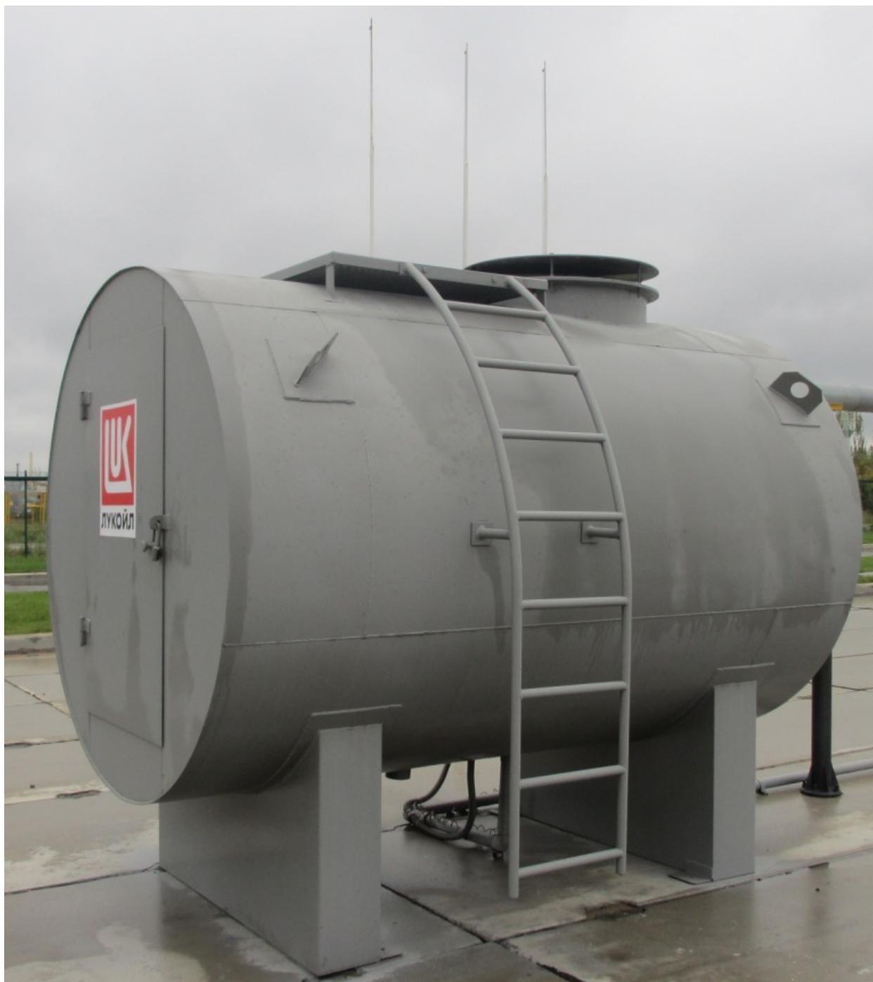
Тренажер представляет собой макет резервуара с люком. Около люка расположена площадка обслуживания, к которой подходит лестница. Материал тренажера – нержавеющая сталь. Для обслуживания оборудования тренажера, расположенного внутри, в одной из боковых стен имеется дверь. Внутри резервуара имеется технологический пол (из металла), а в днище имеется прямоугольное отверстие для слива попадающей при тушении воды.
