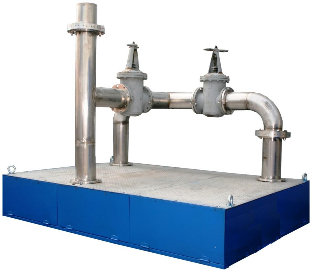
Тренажер представляет собой макет участка газопровода с двумя вентилями и двумя источниками пожара. Каждый из вентилей имитирует перекрытие подачи газа к соответствующему источнику пожара. Диаметр трубопровода 200мм. Материал – нержавеющая сталь. Макет расположен на постаменте высотой 0,5 м.
