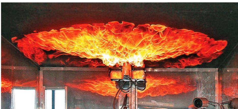
**Имитатор возгорания кровати** представляет собой сетчатую кровать размером 160x90 см. Вмонтированные в горизонтальную поверхность кровати горелки создают небольшое пламя, которое постепенно увеличивается и охватывает всю поверхность кровати. Для контроля за тушением пламени в имитатор вмонтированы датчики.
