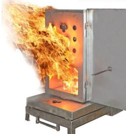
**Имитатор горящего электрошкафа** представляет собой металлический шкаф. Имитация горения электрошкафа, осуществляется при помощи газовых горелок расположенных внутри шкафа. Тренажер поддерживает один уровень горения. При правильной подаче и расходе огнетушащего вещества на охлаждение и тушение шкафа, происходит отключение подачи газа, прекращается горение и на пульт управления подается сигнал о выполнении упражнения.
