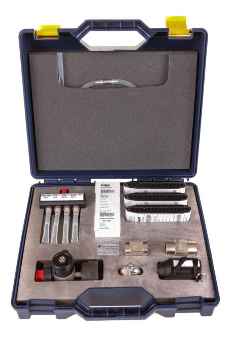
ПТС «Тест-комплект» предназначен для проверки качества воздуха, заправляемого в баллоны дыхательных аппаратов компрессорными установками или системами подачи воздуха высокого давления, и может использоваться везде, где для дыхания применяется сжатый воздух (на базах ГДЗС, в шахтах, в аварийно-спасательных службах, на предприятиях нефтегазового комплекса и химической промышленности, службах, имеющих на вооружении дыхательные аппараты для подводного плавания и т.п).
