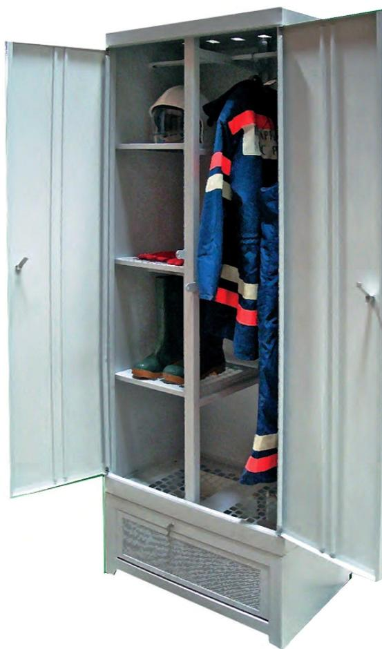
Шкаф для сушки боевой одежды пожарного позволяет быстро и деликатно высушить до 6 комплектов курток и брюк Б ОП или разное количество снаряжения, в зависимости от конфигурации полезного объема. Температурный режим внутри шкафа при сушке регулируется от +20°C до +60°C, что гарантирует деликатную и качественную сушку и в 2-3 раза продляет срок службы объекта сушки.
