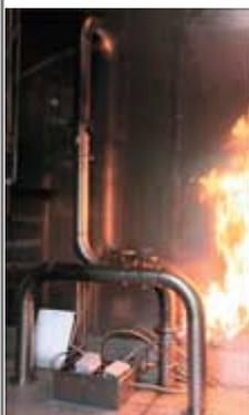
**Огневой модуль «Фланец»** состоит из двух труб с фланцами и запорными кранами. Труба 1: утечка снизу, труба 2: утечка сверху. Поворотом запорного крана огонь «утихает».
