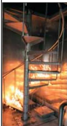
**Огневой модуль «Винтовая лестница»** представляет собой винтовую лестницу с перилами и 12 ступеньками. Горелки вмонтированы в трёх нижних ступеньках и распределены равномерно, возгораются последовательно с определенным интервалом времени. Поток газа увеличивается постепенно, увеличивая интенсивность пламени.
