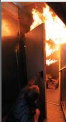
**Огневой модуль «Горящая дверь»** состоит из дверной коробки, двери и ручки. Горелки вмонтированы в дверную коробку и дверь. В закрытом положении дверь нагревается изнутри. При открытии дверь и коробка воспламеняются, имитируя эффект
