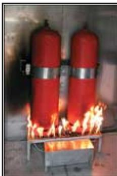
**Огневой модуль «Газовые баллоны»** состоит из двух баллонов, стоящих вертикально на подставке. Оба нагреваются пламенем снизу и изнутри. Выходное отверстие для пламени расположено сверху. Встроенные горелки выпускают пламя по достижению определенной температуры.
