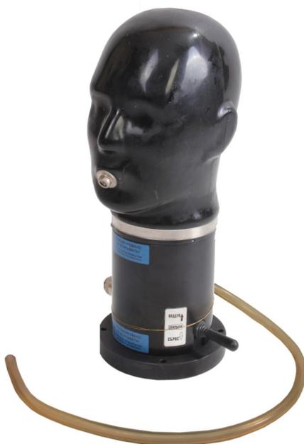
Муляж головы надувной предназначен для динамических испытаний дыхательных аппаратов и их лицевых частей.
