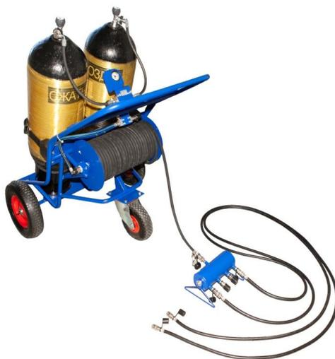
Мобильная баллонная система «Модуль-М» (имеет Сертификат соответствия ГОСТ Р) предназначена для хранения, транспортирования и подачи сжатого воздуха для обеспечения дыхания человека в токсичной и задымленной газовой среде и применяется при температуре окружающей среды от  $-40^{\circ}\text{C}$  до  $+60^{\circ}\text{C}$  и относительной влажности воздуха до 95%. Система предусматривает возможность одновременной работы до пяти пользователей.
