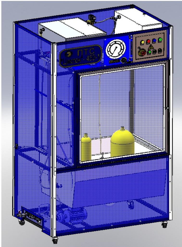
Установка для гидравлических испытаний малолитражных баллонов на сжатом воздухе ПТС "ЦИКЛОН"-450 предназначена для одновременного испытания пробным давлением малолитражных баллонов для дыхательных аппаратов и самоспасателей на сжатом воздухе различных типоразмеров, а также баллонов для промышленных газов в полуавтоматическом режиме.
