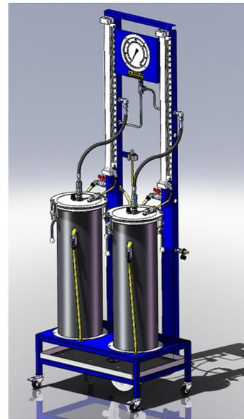
Установка для гидравлических испытаний малолитражных баллонов на сжатом воздухе ПТС "ЦИКЛОН"-450-1 предназначена для одновременного испытания пробным давлением малолитражных баллонов для дыхательных аппаратов и самоспасателей на сжатом воздухе различных типоразмеров, а также баллонов для промышленных газов в полуавтоматическом режиме.
