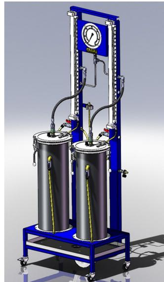
Установка для гидравлических испытаний малолитражных баллонов на сжатом воздухе ПТС "ЦИКЛОН"-450-2 предназначена для одновременного испытания пробным давлением малолитражных баллонов для дыхательных аппаратов и самоспасателей на сжатом воздухе различных типоразмеров, а также баллонов для промышленных газов в
