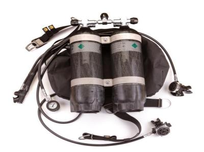
Аппарат автономный водолазный дыхательный ПТС «АВМ-450» предназначен для обеспечения дыхания водолаза при выполнении им различных водолазных работ на глубинах до 60 м, в том числе в условиях низких температур воды и воздуха. В зависимости от комплектности, аппарат может использоваться как в автономном режиме, так и служить резервным дыхательным аппаратом при использовании со снаряжением в шланговом варианте с открытой схемой дыхания либо вентилируемым типа трехболтового или СВС-20.
